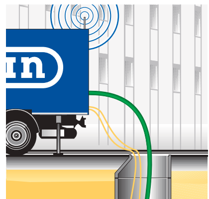
Bild 3: Dampfcontainer mit integrierter Prozesssteuerung
