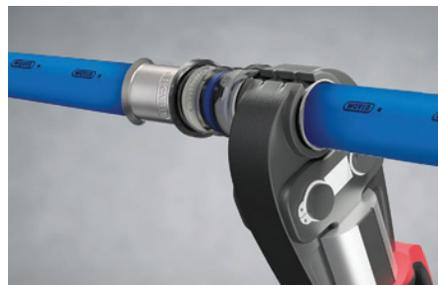
**05** Coloque la herramienta de presión a 90° con respecto al nivel de la conexión
