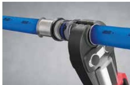
**05** Coloque la herramineta de presión a 90° con respecto a la conexión
