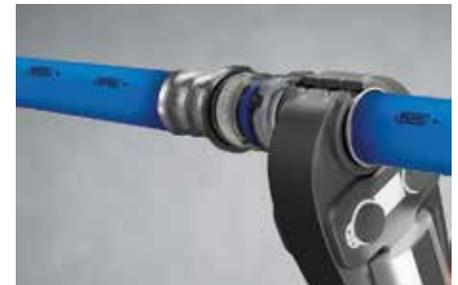
**06** Accione firmemente herramienta sobre la conexión, hasta lograr que el casquillo reproduzca la forma de la mandíbula de la herramienta en ambos lados, según aplique
